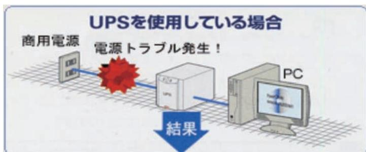
停電時のバックアップ電源。落雷で発生するサージ電圧を吸収し医療機器の破損を防ぐ。
